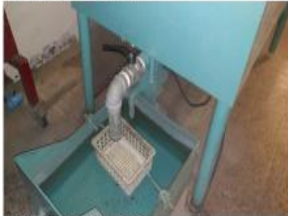
Colador – Toma de Muestra
